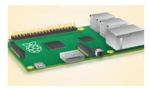
Fig.4. Raspberry Pi module [9]
